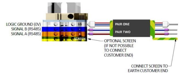
Wiring Diagram 2 – Modbus
